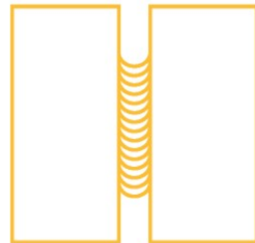
Belleli Monoweld One weld bead per layer
